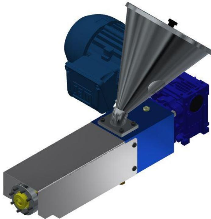
**Micro injetor Autônomo com Servo Motor.**
